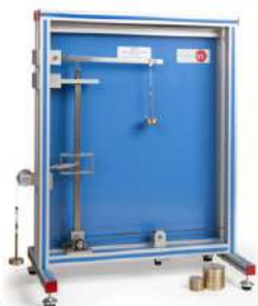
▶ MCD. Moduł do badania cylindra cienkościennego
