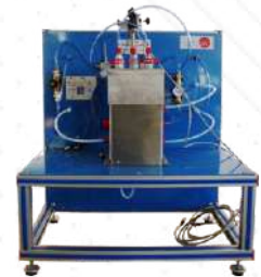
QRAD. Reaktor adiabaticzny i izotermiczny
