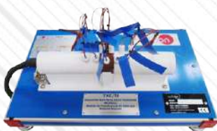
TXC/TF. Moduł transferu ciepła z materiału izolacyjnego dla TSTCC
