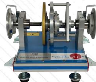
▶ MEC. Moduł przekładni przyspieszającej
