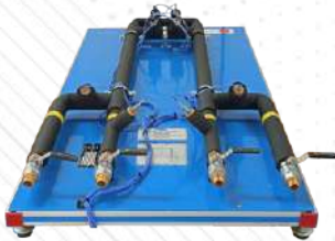
TIIC. Koncentryczny rurowy wymiennik ciepła dla TIIC
