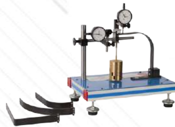
▶ MFLT. Wyboczenie konstrukcji przez ściskanie
