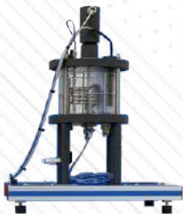
QRAC. Sterowany komputerowo reaktor zbiornikowy z ciągłym mieszaniem dla QRC
