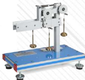
▶ MMF. Jednostka siły ścinającej i momentu zginającego
