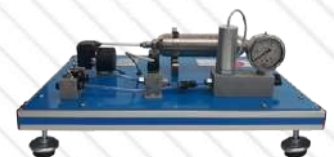
RYC-P. Moduł kontroli ciśnienia
