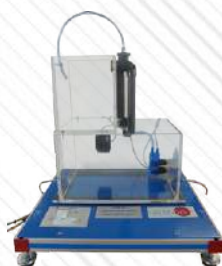
RYC-C. Moduł kontroli natężenia przepływu
