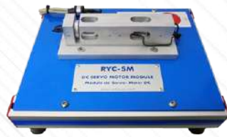
RYC-SM. Moduł silnika serwo DC
