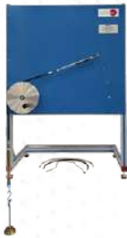
▶ MCF/A. Jednostka tarcia taśmy z dynamometrami
