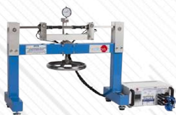
▶ MFGE. Jednostka do określania współczynnika pomiarowego tensometrów
