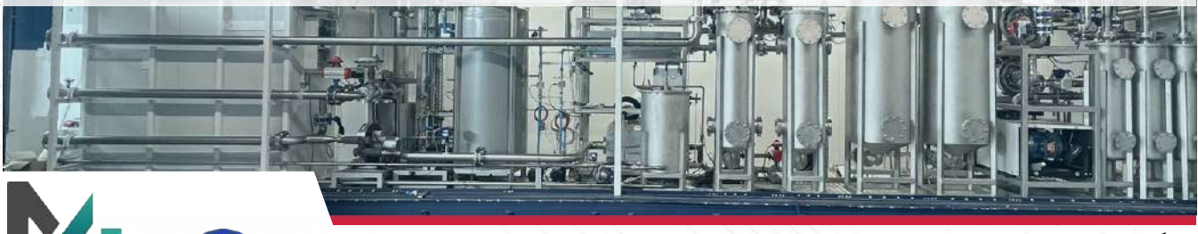
MOF4AIR. Instalacja pilotażowa do wychwytywania adsorpcyjnego CO 2 . [NORWEGIA, TURCJA and FRANCJA]
