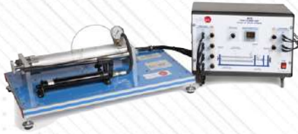
▶ MCF/A. Jednostka tarcia taśmy z dynamometrami
