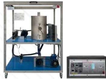
AV-ECC. Stanowisko dydaktyczne obwodu chłodzenia silnika samochodowego
