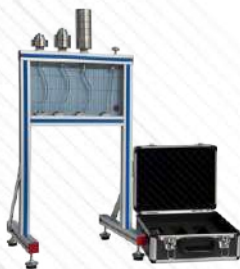
▶ MMF. Jednostka siły ścinającej i momentu zginającego
