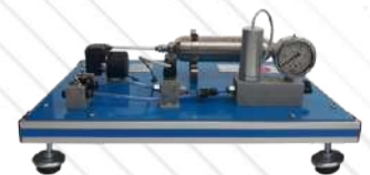
RYC-P. Moduł kontroli ciśnienia
