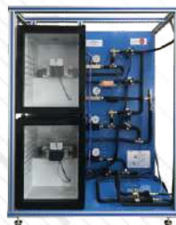
TRAMC/2. Model systemu chłodniczego z etapem chłodzenia i zamrażania
