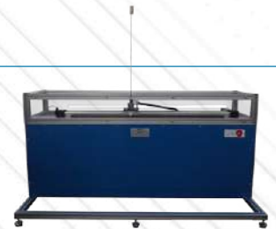
RYC-PI. Moduł sterowania odwróconym wahadłem
