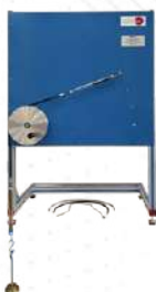
▶ MCF/A. Jednostka tarcia taśmy z dynamometrami
