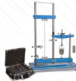
▶ MUP. Uniwersalna jednostka badania wyboczenia
