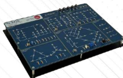
N-M16. Moduł sieci elektrycznych.
