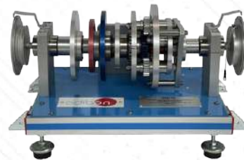
▶ MEC. Moduł przekładni przyspieszającej
