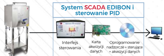
RDC. Moduł szkoleniowy urządzenia do produkcji twarogu
