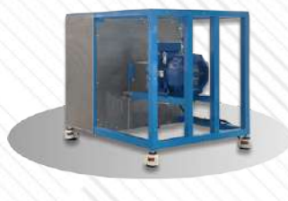
PWP-FE. Elektrownia z kotłem zamachowym magazynująca energię
