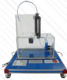
RYC-C. Moduł kontroli natężenia przepływu
