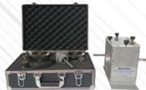
MDU-SSDG. Zestaw do badania uszkodzeń w Gears
