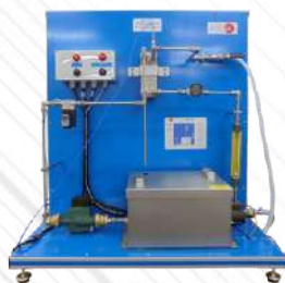
RYC-TAG. Moduł kontroli temperatury przepływu wody
