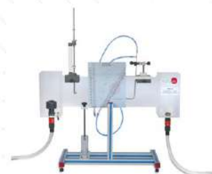
FME25. Kanał przepływowy, długość: 1 m
