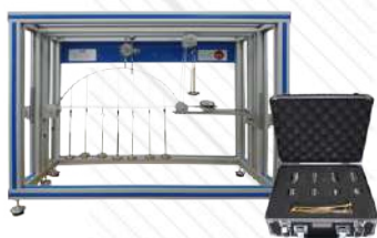
▶ MFBS. Jednostka do badania sił w prostej konstrukcji prętowej
