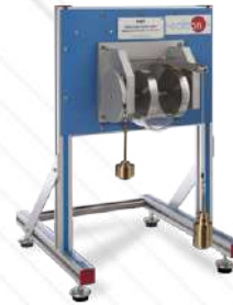
MEF. Jednostka badania tarcia
