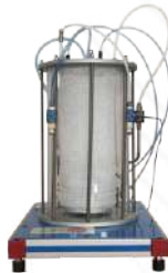
QRTC. Sterowany komputerowo rurowy reaktor przepływowy dla QRC
