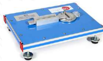
▶ MBM2. Mechanizm szybkiego ruchu powrotnego Whitwortha
