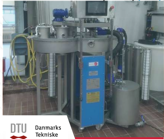
SLE00. Sterowana komputerowo i wyposażona w ekran dotykowy instalacja pilotażowa do ekstrakcji ciał stałych i cieczy. [DANIA]
