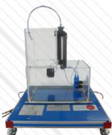
RYC-N. Moduł kontroli poziomu
