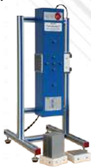
TXC/FF. Moduł swobodnego i wymuszonego konwekcyjnego transferu ciepła dla TSTCC
