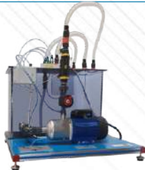
HT-FA. Model turbiny o przepływie osiowym
