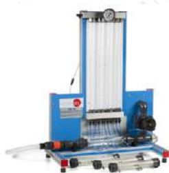
FME24. Jednostka do badania złoza porowatego w zwężkach Venturiego (równanie Darcy'ego)
