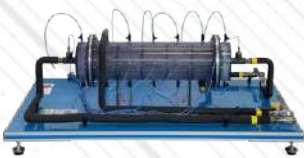
TICT. Płaszczowo-rurowy wymiennik ciepła dla TIIC
