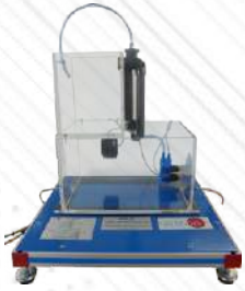
RYC-N. Moduł kontroli poziomu
