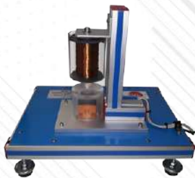
RYC-CLM. Moduł sterowania lewitacją magnetyczną
