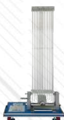
MEMT-1. Rozkład ciśnienia promieniowego w łożysku poprzecznym
