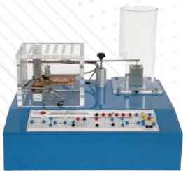
BS1. Moduł testowania drgań i odkształceń
