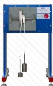
MELH. Jednostka do studiowania prawa Hooke'a
