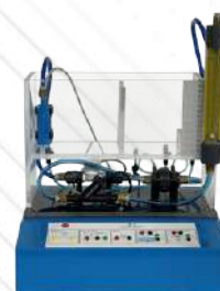
BS4. Moduł testów przepływu
