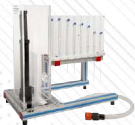
FME17. Kryza i swobodny przepływ strumienia
