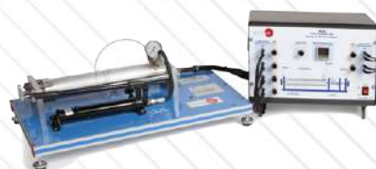
MWV. Stanowisko niesymetrycznego wspornika
