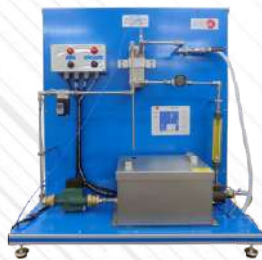
RYC-TAG. Moduł kontroli temperatury przepływu wody
