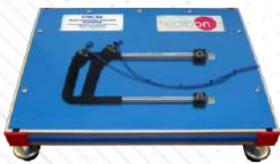
TITC/SS. Podstawowy koncentryczny rurowy wymiennik ciepła
