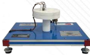
TXC/CR. Moduł promieniowego przewodzenia ciepła dla TSTCC
