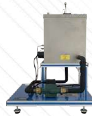
TXC/EI. Moduł przenoszenia ciepła w stanie nieustalonym dla TSTCC
