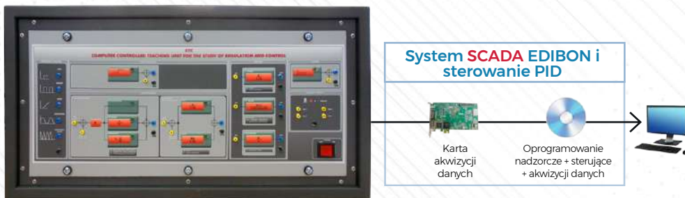
RYC. Sterowana komputerowo jednostka dydaktyczna do nauki regulacji i sterowania
