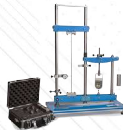
▶ MUP. Uniwersalna jednostka badania wyboczenia
