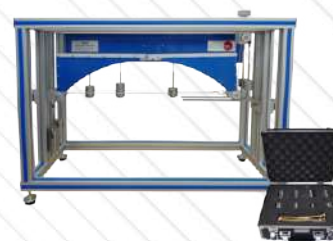
▶ MFCSI. Jednostka do badania sił w różnych kratownicach jednopłaszczyznowych
