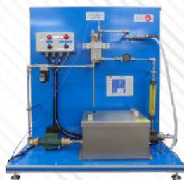
RYC-TAG. Moduł kontroli temperatury przepływu wody
