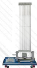
MEMT-1. Rozkład ciśnienia promieniowego w łożysku poprzecznym
