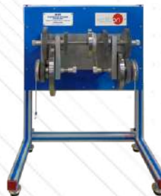
▶ MCDA. Zespół montażowy połączonych napędów
