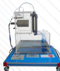
RYC-TE. Moduł kontroli temperatury
