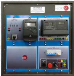
AEL-FUSC-M. Użytkownik końcowy Smart Grid - aplikacja inteligentnego licznika
