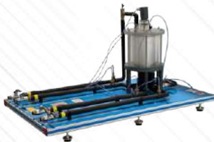
TIVE. Wymiennik ciepła z płaszczem wodnym dla TIIC
