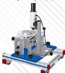
MEMT-1. Rozkład ciśnienia promieniowego w łożysku poprzecznym
