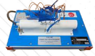
TXC/TC. Ceramiczny moduł wymiany ciepła dla TSTCC
