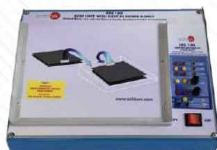
EBC100. Jednostka bazowa z wbudowanym zasilaczem
