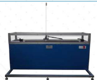
RYC-PI. Moduł sterowania odwróconym wahadłem
