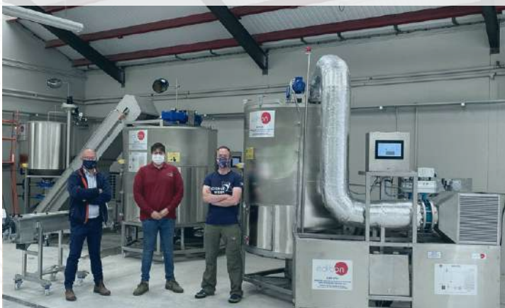
CE00/MA. Instalacja pilotażowa do słodowania zbóż. [IRLANDIA]
