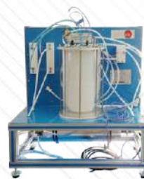
QRFT. Rurowy reaktor przepływowy
