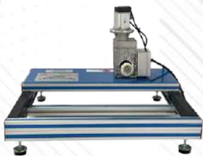
MEMT-UB. Jednostka napędowa do testów tribologicznych
