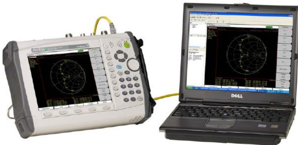
Ilustracja 2-17. Połączenie MS2028C do komputera przez USB Mini-B
