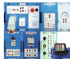
Ai5. Rozrusznik silnika AC z uzwojenym wirnikiem
