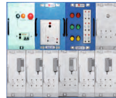
AD17A. Stanowisko sterowania położeniem za pomocą czujników fotoelektrycznych
