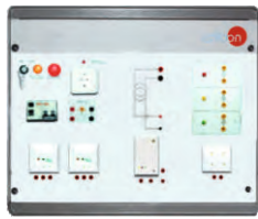
AD1A. Stanowisko instalacji antywłamaniowej
