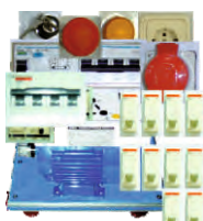
KI7. Zestaw automatycznej zmiany prędkości silnika Dahlandera wraz ze zmianą kierunku obrotów
