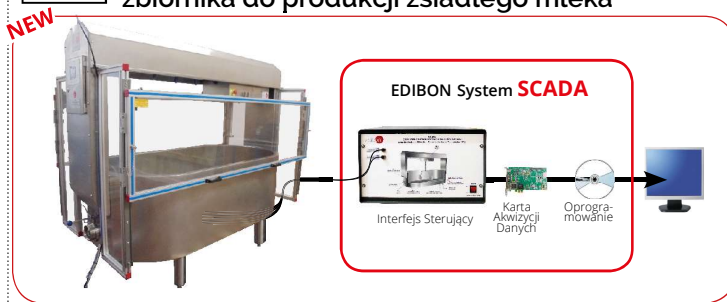
CCDC. Sterowany komputerowo moduł szkoleniowy zbiornika do produkcji zsiadłego mleka
