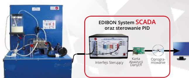
PASC. Sterowany komputerowo pasteryzator laboratoryjny
