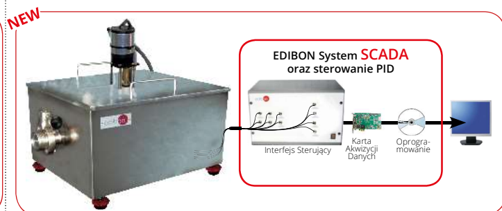
AEQC. Sterowana komputerowo kadź do sera i akcesoria do formowania sera
