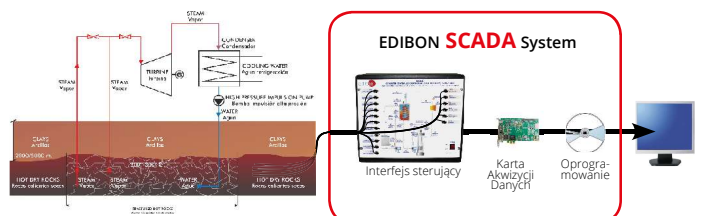
EG6C Sterowana komputerowo siłownia geotermiczna (o wysokiej entalpii)
