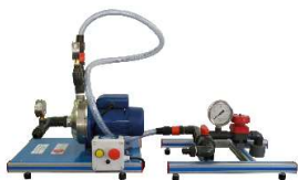
Pompy w układzie szeregowym/równoległym
