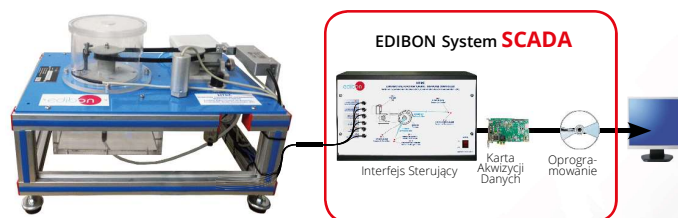
HTRC. Wspomagana komputerowo eksperymentalna turbina reakcyjna
