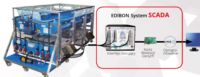
ESHC (4x2m). Sterowany komputerowo Moduł systemów hydrologicznych, symulatora deszczu i nawadniania(4x2m)
