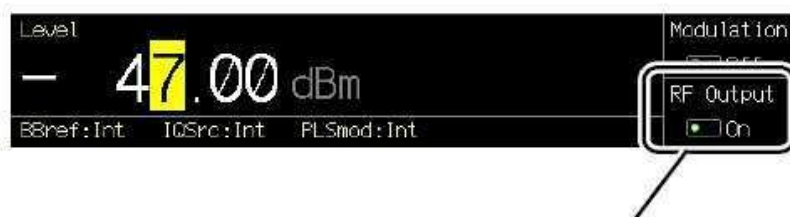
Wyświetlanie stanu wyjścia RF
