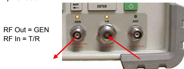
Rys. 3-26 Dwuportowa konfiguracja testowa duplex GEN/TR
