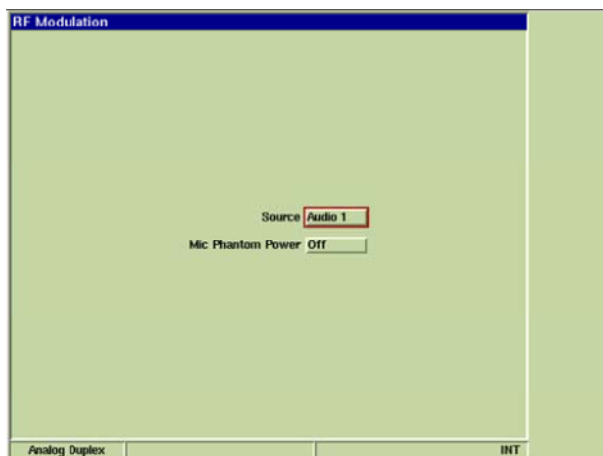
Rys. 7-4 System AnalogDuplex – okno konfiguracji generatora modulacji
