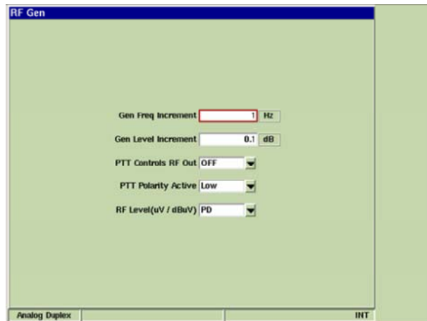
Rys. 7-6 System Analog Duplex – okno konfiguracji generatora RF
