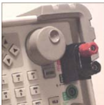
Rys. 6-43 Zainstalowany bocznik prądowy
