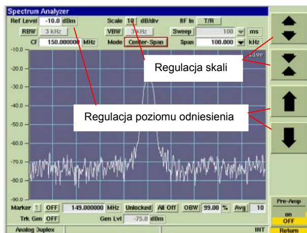
Rys. 6-32 Okno analizatora widmowego – ustawienie w pionie
