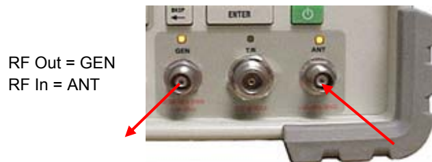
Rys. 3-25 Dwuportowa konfiguracja testowa duplex GEN/ANT
