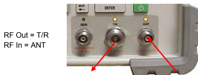
Rys. 3-27 Dwuportowa konfiguracja testowa duplex TR/ANT
