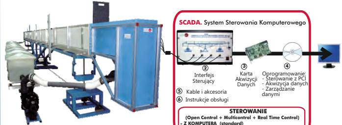
① CFGC. Kanały przepływowe (przekrój: 300 x 450 mm).
