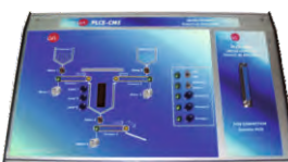
PLCE-CME. Sterowanie pracą mieszalnika
