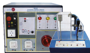
Ad22. Stanowisko sterowania natężeniem przepływu
