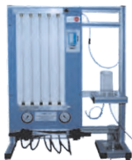
FME22. Moduł do demonstracji dyszy Venturiego, prawa Bernoulliego i kawitacji
