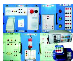
Ai4. Rozrusznik z przemiennikiem częstotliwości
