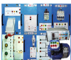
Ai2. Rozrusznik z autotransformatorem
