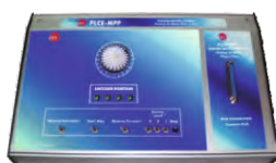
PLCE-MPP. Sterowanie pracą silnika krokowego
