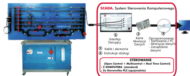
ⓐ AFTC. Stanowisko do badania tarcia płynów w rurach ze stanowiskiem do układów hydraulicznych. (FME00).
