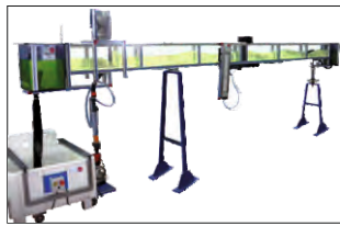
① CFC. Kanały przepływowe (przekrój: 80 x 300 mm).
