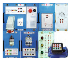
Ai5. Rozrusznik silnika AC z uzwojenym wirnikiem
