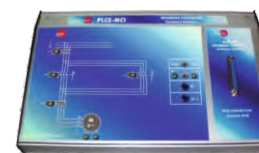
PLCE-MCI. Układ stycznikowy nawrotny
