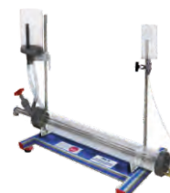
FME31. Poziomy układ do demonstracji prawa Osborne'a-Reynoldsa
