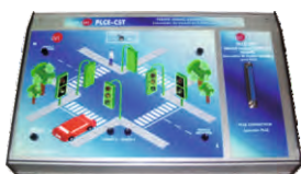
PLCE-CST. Sterowanie uliczną sygnalizacją świetlną
