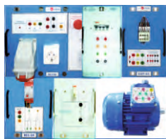
AI7. Automatyczna zmiana prędkości silnika Dahlandera wraz ze zmianą kierunku obrotów
