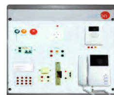
Ad14. Układ domofonu audio - wideo
