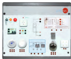
AD3A. Stanowisko alarmu przeciwpożarowego
