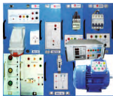
AI3. Komutator prędkości w silniku Dahlandera
