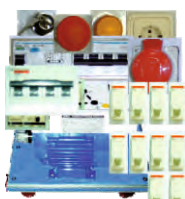
KI7. Zestaw automatycznej zmiany prędkości silnika Dahlandera wraz ze zmianą kierunku obrotów
