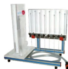
FME17. Przepływ przez krzyż i strumień swobodny
