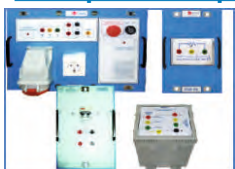
AE3. Jednostka testowania termomagnetycznych wyłączników automatycznych
